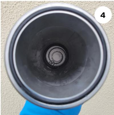
Greifen Sie mit der Hand hinein und drücken Sie die Andrückfeder gegen die Unterseite des Kerzenfiltergehäuse.
