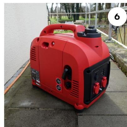
Schalten Sie den Stromgenerator gemäß der Bedienungsanleitung ein, **bevor Sie die Pumpe oder ein anderes Gerät anschließen.**
