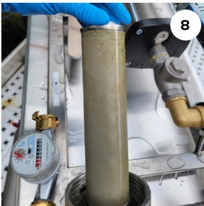
Fassen Sie die Edelstahlgewebekerze von innen mit den Fingern an und legen Sie sie in das Becherglas.
