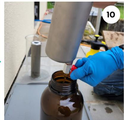
Spülen Sie das Wasser durch das Ventil 2 in die Probennehmf Flasche. Wiederholen Sie dies zwei- bis dreimal.
