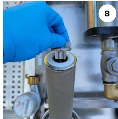
Fixieren Sie die Edelstahlgewebekerze mit der Schraube am unteren Ende.
