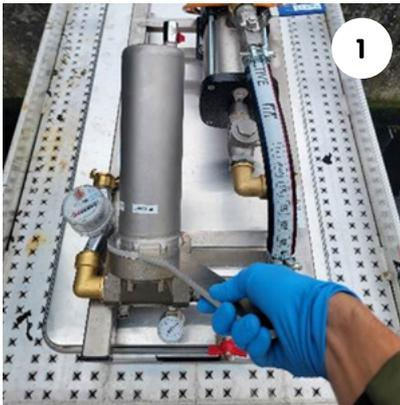
Öffnen Sie mit Hilfe des Ringschlüssels das Kerzenfiltergehäuse.
