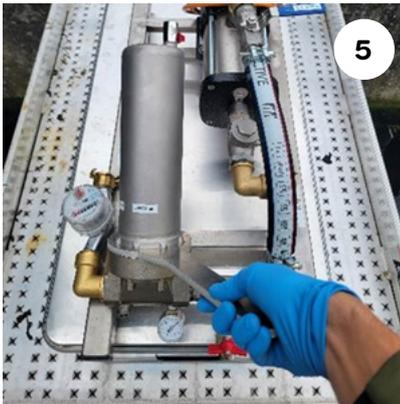
Verwenden Sie den Ringschlüssel, um das Kerzenfiltergehäuse zu lösen und zu öffnen.
